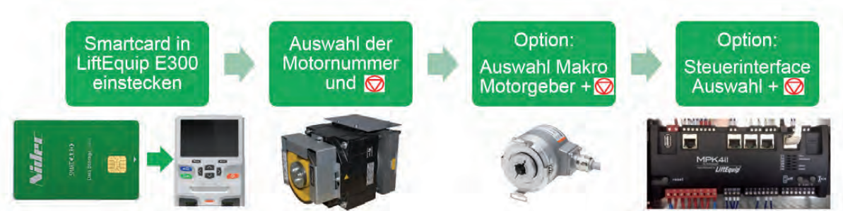
Bild 11: Inbetriebnahme und Parametrierung
